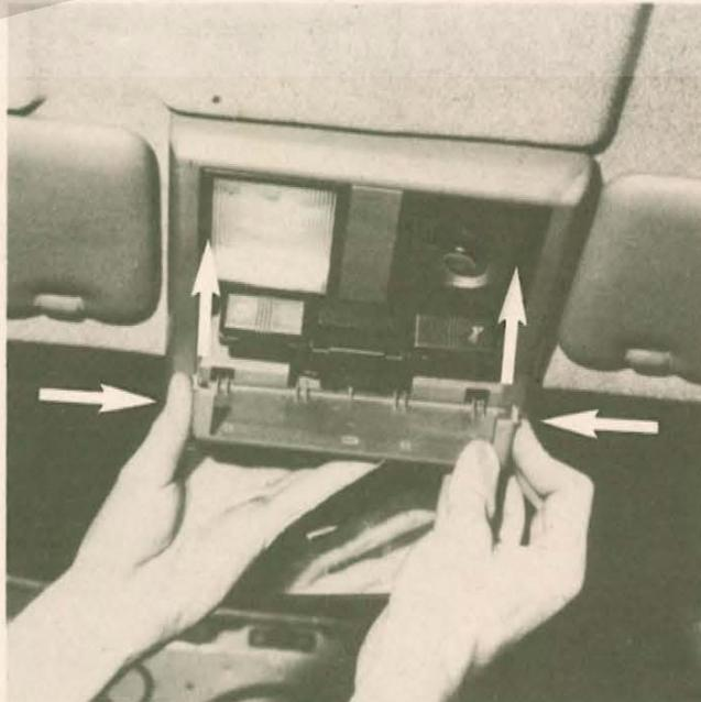
Zum Ausbau Druck nach innen auf die beiden Flanken des Abdeckgehäuses ausüben, um die Federzungen zu lösen. Das Gehäuse nach vorne abziehen.
