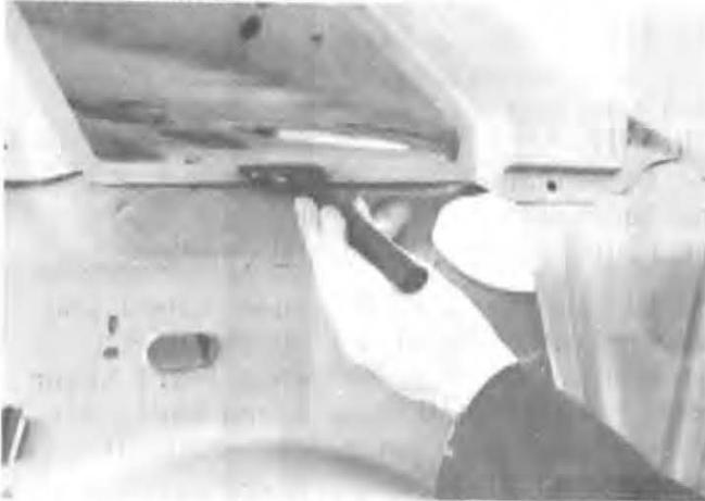
Den unteren Rand des hinteren Seitenfensterrahmens mit einem Stemmer auf die Seitenblechverstärkung umlegen, so daß die Blechstärke der überlappend angeschweißten hinteren Seitenwand ausgeglichen wird. 90509
